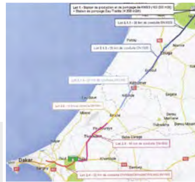
Le tracé de la conduite de KMS3.
